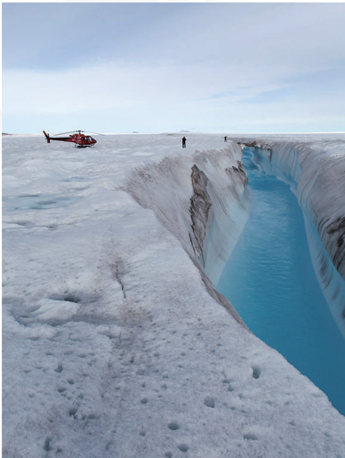
图 2：丹麦技术大学的科研人员们降落在冰原上安装全球定位系统站点，这些站点能够非常准确和高精度地测量冰原的冰流水平和垂直运动。图片由丹麦技术大学空间系的什法卡特·阿巴斯·汗提供。
